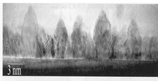
Рост осуществляется в несколько стадий: на начальной стадии роста формируется зародышевый слой, идет образование дислокаций несоответствия и появляются островки (нанодомены) с размерами от нескольких до десятков нанометров, имеющие разные углы наклона и разворота оси с относительно друг друга (рис. 3).
